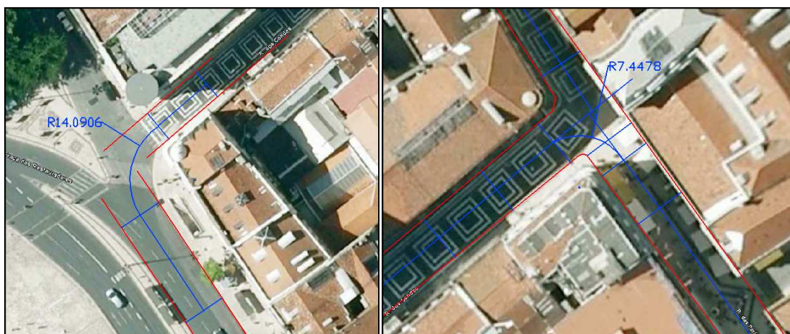
Fig. 3.2. – Medição dos raios das curvas nas vias de acesso ao Teatro Politeama: Rua dos Condes (esquerda) e Rua das Portas de Santo Antão (direita)
