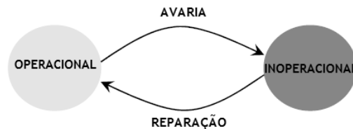
Figura 4.1- Comportamento de um sistema reparável
