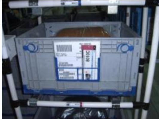
Figura 28 – Kanban de produção em caixa de produto acabado
