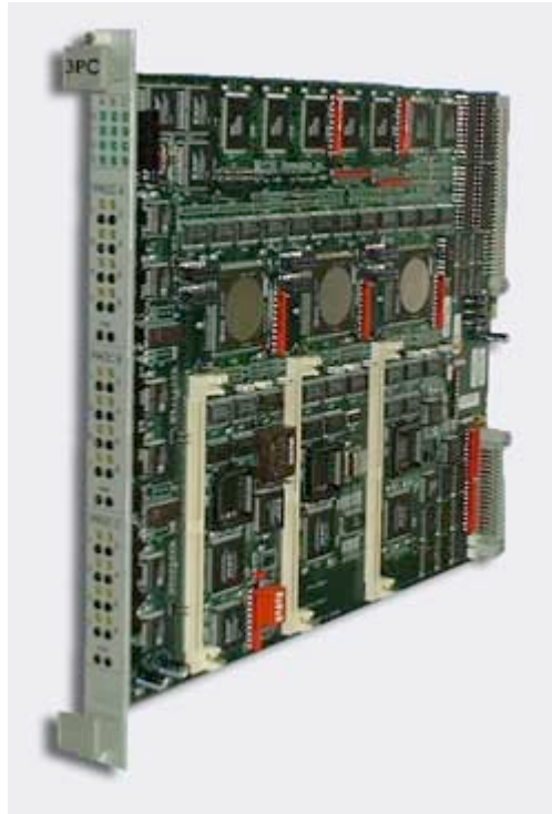
Figura 4.2: Placa 3PC - Triple Processor
