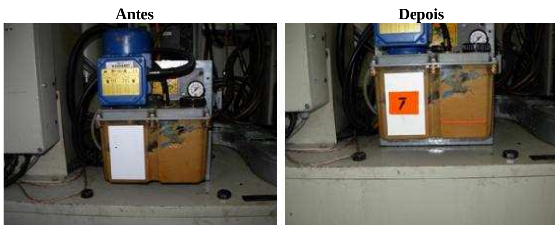
Figura 32 – Marcação do nível de massa do sistema de lubrificação central da máquina de soldar
