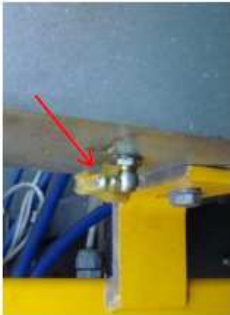
Fig. 28 - Um dos "grasseur" a lubrificar
