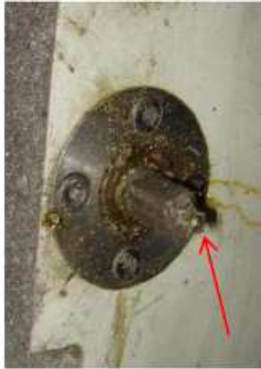
Fig. 16 - "Grasseur" eixo regulação
