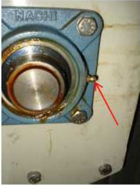
Fig. 28 - Um dos "grasseur" a lubrificar
