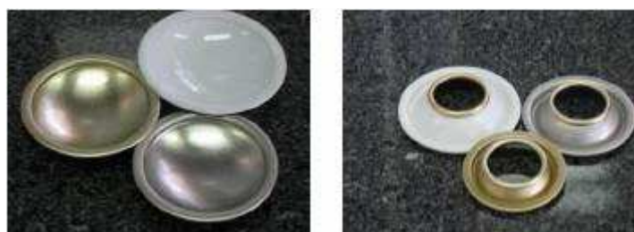
Figura 8 – Componentes da estampagem: fundos e cúpulas
