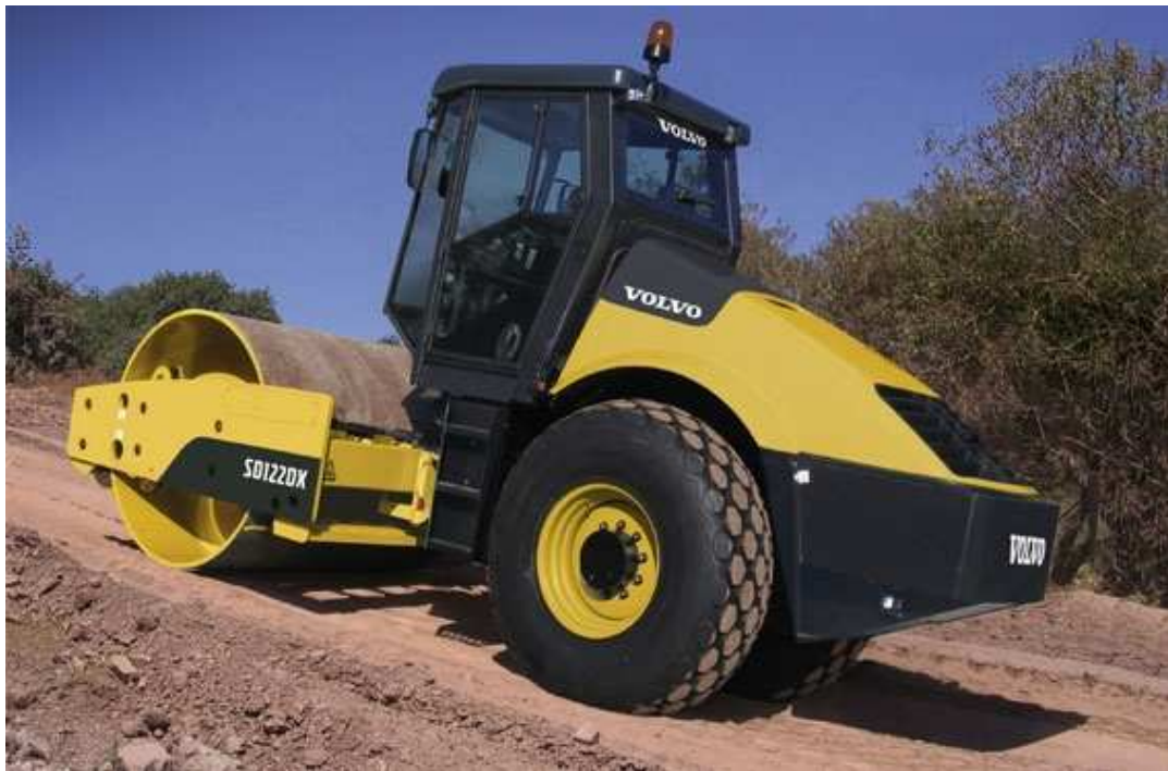
Fig.22 – Cilindro Vibrador Rolo Liso Volvo SD122D [24].
