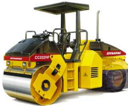
Fig.14 – Cilindro Misto (Rolo Liso – Pneus) [17]
