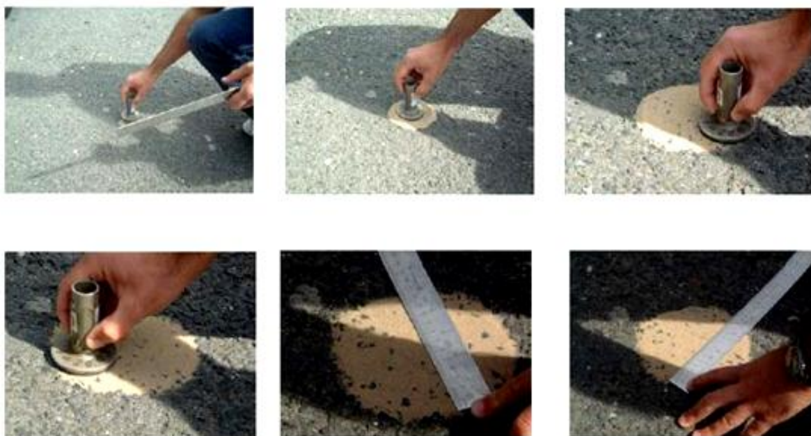
Fig.2.36 – Sequência da Técnica do ensaio da Mancha de Areia normalizada. [7]
