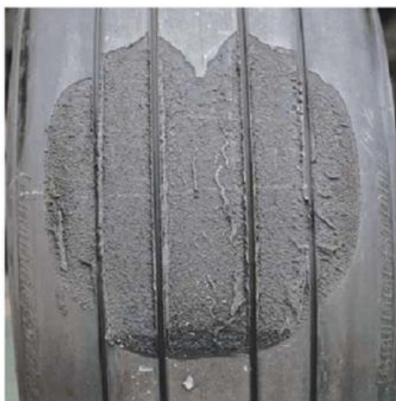
Fig.2.9 – Zona de rodagem de um pneu aeronáutico que sofreu hidroplanagem por desvulcanização. Goodyear (2003)
