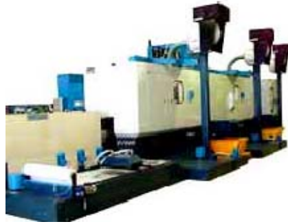
Fig 2.2 – Linha de maquinação de automáticos de gás para esquentadores
