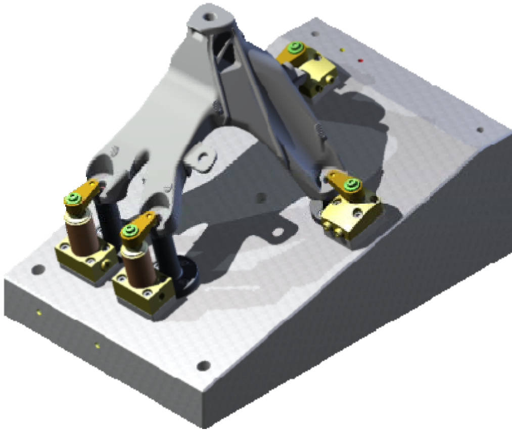
Fig 4.1 - Dispositivo de aperto concebido neste trabalho, e peça 8KO 199 308 BE
