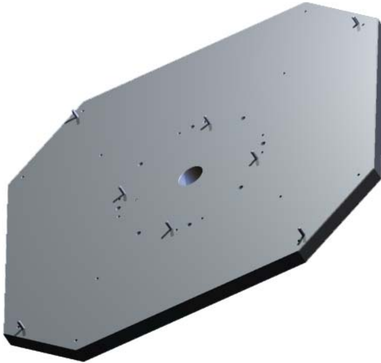
Fig 4.24 – Falso prato e cavilhas de posicionamento.
