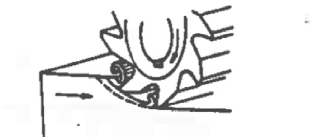
Fig 4.33 – Fresagem cilíndrica tangencial*.
