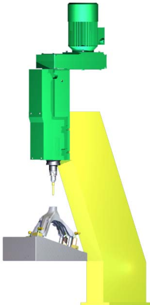
Fig 4.46 – Furadora Somex Max 20F integrada na coluna da unidade de furação e dispositivo de aperto com a peça a ser processada.
