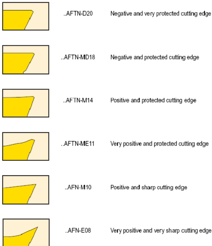
Fig B.1 - Exemplos de das diferentes geometrias de pastilhas *
