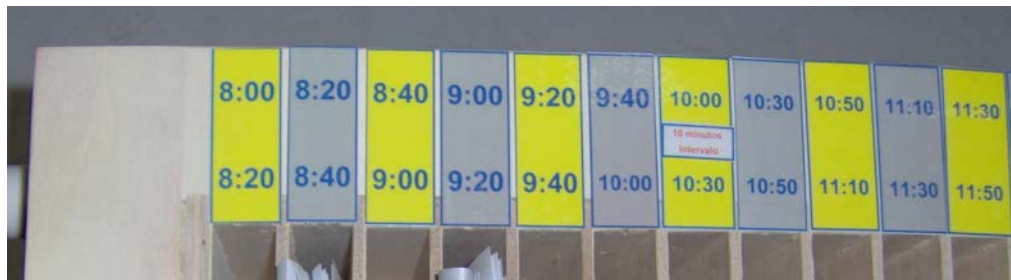
Figura 66 – Colunas da Caixa de Nivelamento
