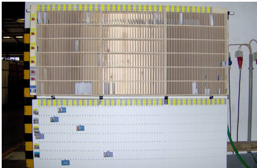
Figura 63 – Caixa de Nivelamento da Oliveira Irmão
