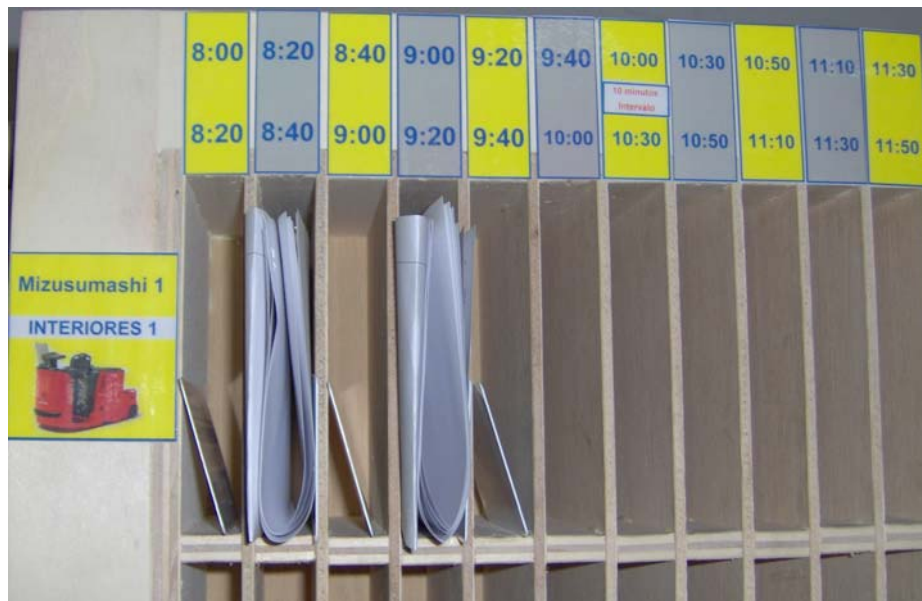
Figura 64 – Pormenor da caixa de nivelamento
