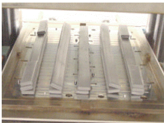
Figura 22: colocação do material lubrificante no molde
