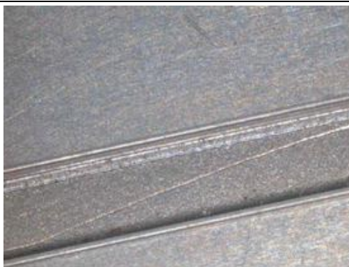
Figura 39: risco no bond channel provocado pela ponteira de aço inoxidável
