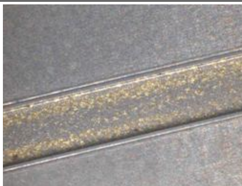
Figura 37: resíduos de latão no bond channel
