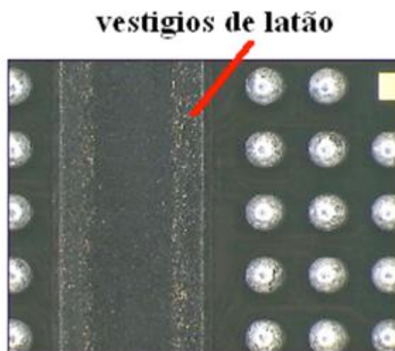
Figura 17: componente com defeito (resíduos de latão)
