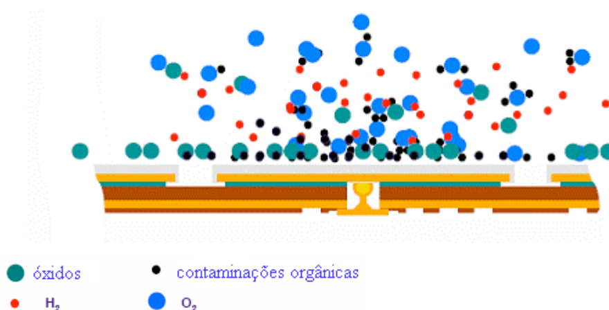
Figura 7: processo de limpeza por plasma
