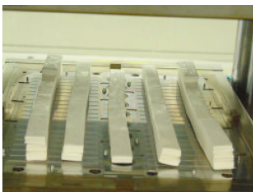
Figura 18: colocação do material de limpeza no molde
