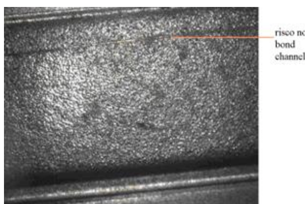
Figura 38: risco no bond channel provocado pelo gito
