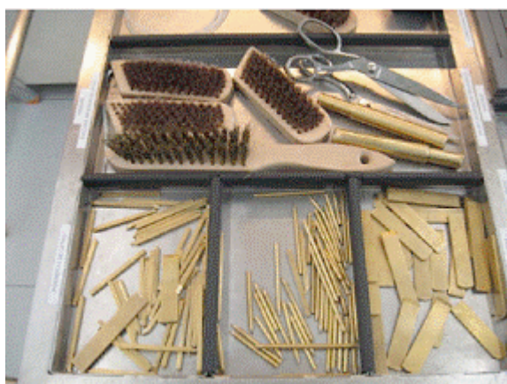
Figura 23: utensílios de latão utilizados em intervenções no molde
