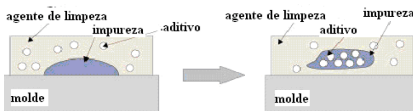
Figura 21: efeito penetrante realizado pela agente de limpeza
