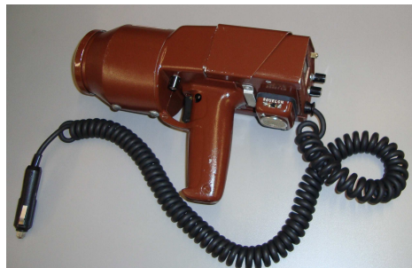
Fig.4.7 – Foto do radar utilizado para medir as velocidades dos automóveis
