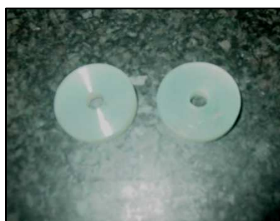
Figura 74 - Junta de vedação em Silicone 60 SHORE obtida por corte de jacto de água
