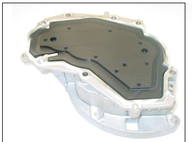
Figura 72 - Intercalar interior montado no cárter de alumínio
