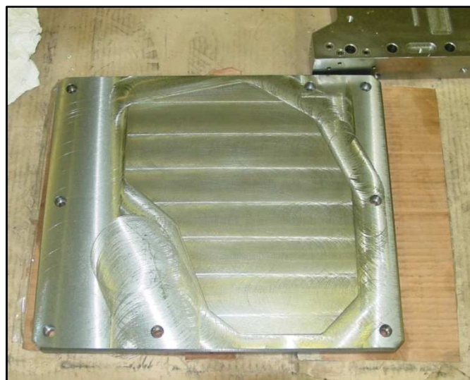
Figura 80 - Base da peça em aço CK 45
