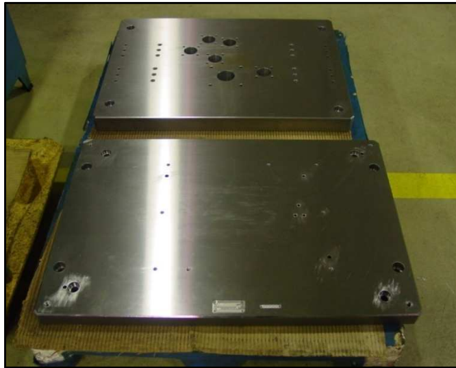
Figura 79 - Base superior e Base inferior em aço CK 45
