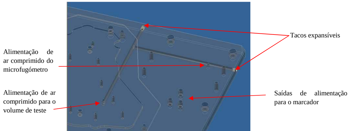
Figura 19 - Pormenor do canal para o ar comprimido do modelo 3D da base.
