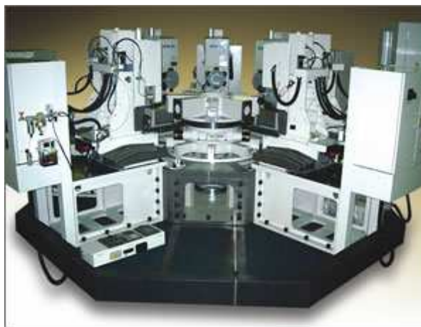
Figura 4 - Máquina CNC rotativa. Retirado de http://www.cmeccanica.com (30 Junho de 2008)
