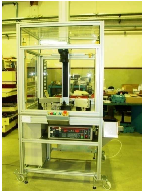
Figura 10 - Máquina de teste de estanquidade para peça em alumínio. Cortesia da SERI, Sociedade de Estudos e Realizações Industriais
