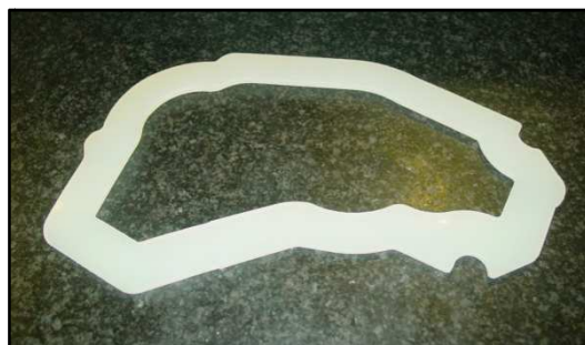
Figura 73 - Junta de vedação em silicone 60 SHORE obtida por corte de jacto de água
