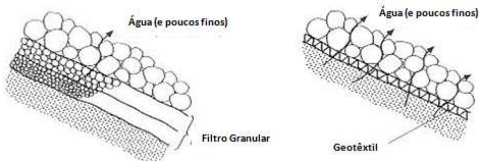
Figura 5.2 - Exemplo esquemático de um filtro granular (esquerda) e de um geotêxtil (direita) [7].
