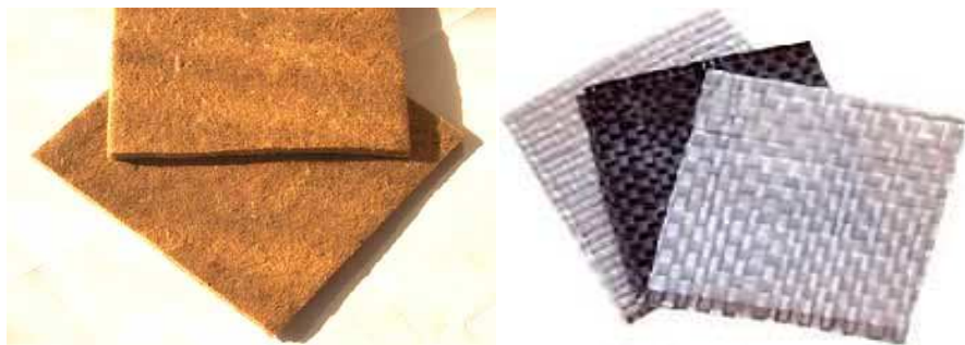
Figura 5.3 - Exemplos de geotextil "não tecido" (esquerda) e "tecido" (direita) [17].
