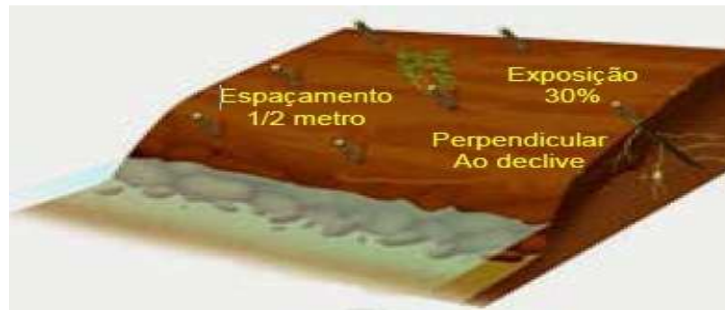
Figura 4.46 - Colocação da estacaria ao longo das margens [5].
