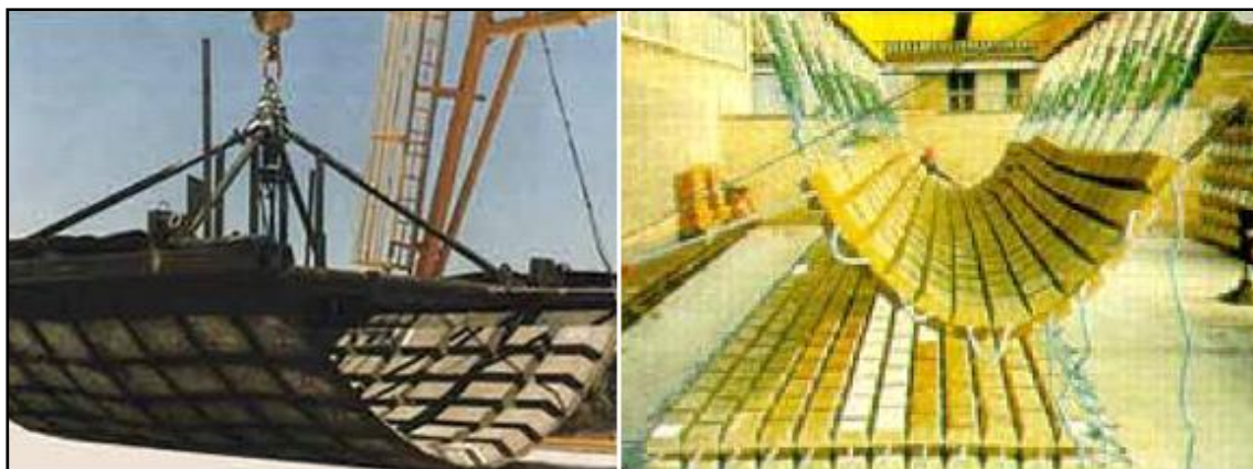
Figura 3.26 – Grelha de blocos de betão, para fundações de estruturas costeiras.
