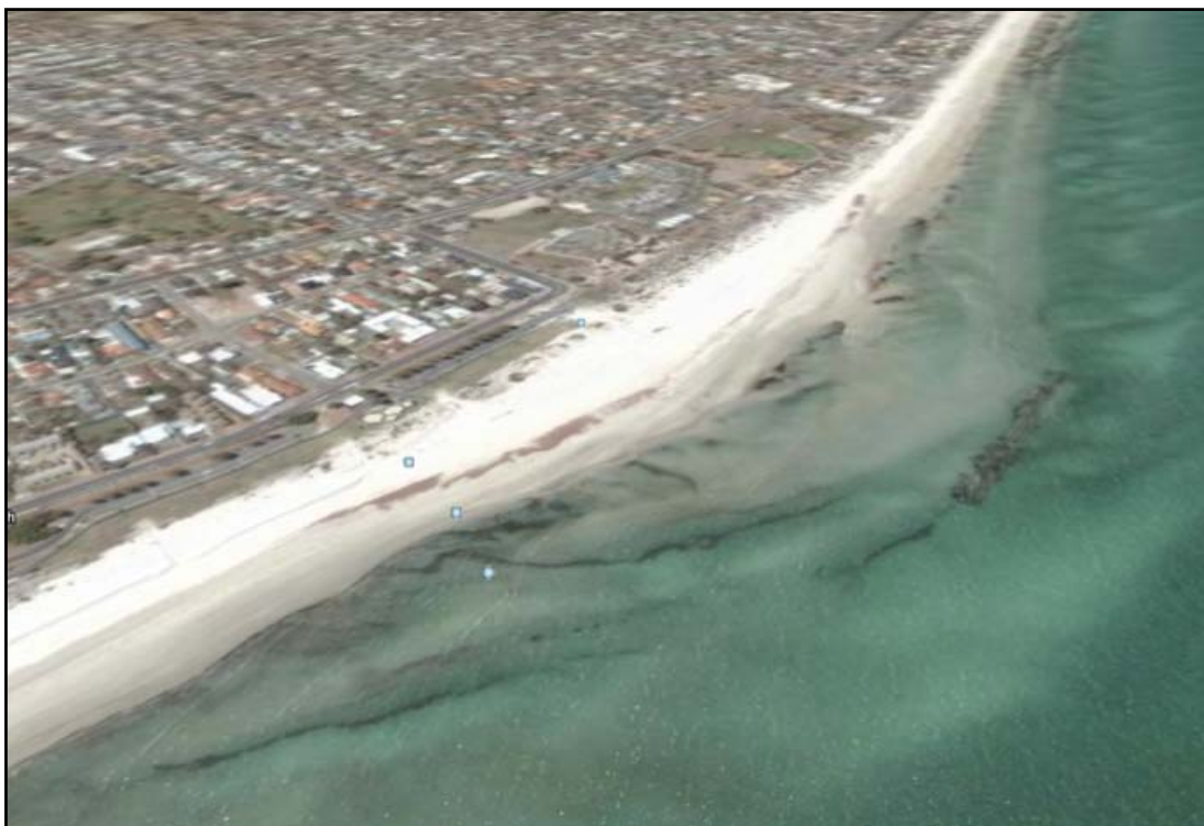
Figura 2.18 – Quebramar destacado sujeito a agitação média/calma, com formação de saliência (Semaphore, Austrália).
