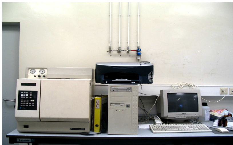
Figura 6. Cromatógrafo Gasoso Finnigan 9001 com detector de captura de electrões (GC-ECD), usado no trabalho.
