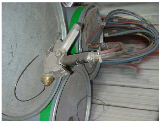
Fig. 4.33 – Pistola para metalização a quente
