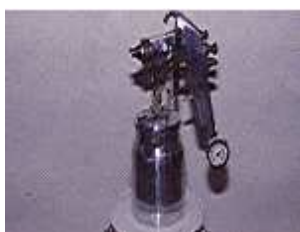
Fig. 4.36 – Pistola convencional com alimentação por aspiração
