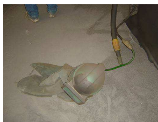
Fig. 4.30 – Granalha de aço, máscara e bico de decapagem
