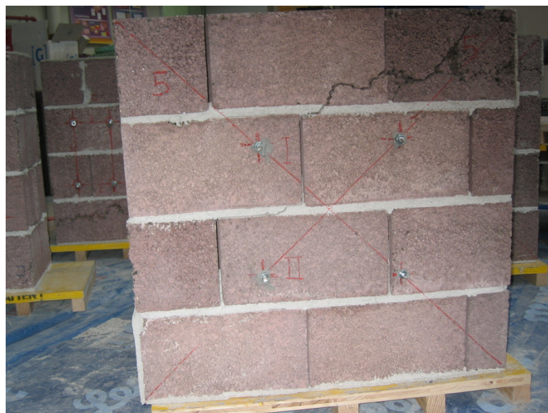
Fig.35 – Provede não revestido após a rotura
