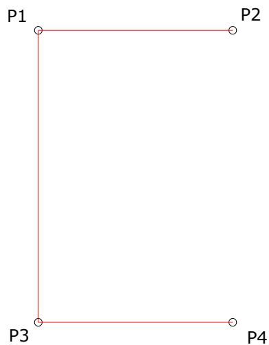
Fig. 33 – Mínima árvore euclidiana correspondente aos dados representados na Fig. 30 (uma das duas soluções possíveis)
