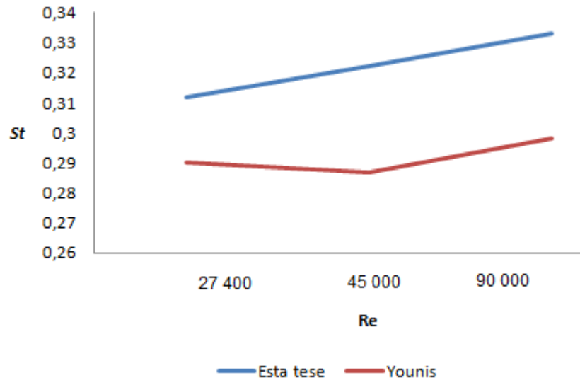
Fig. 22- Resultados obtidos do St em função do número de Reynolds, comparando com a literatura.
