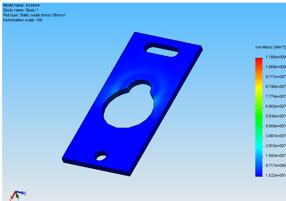
Figura 36. Resultado da análise de tensões da guilhotina com um factor de escala de 100
