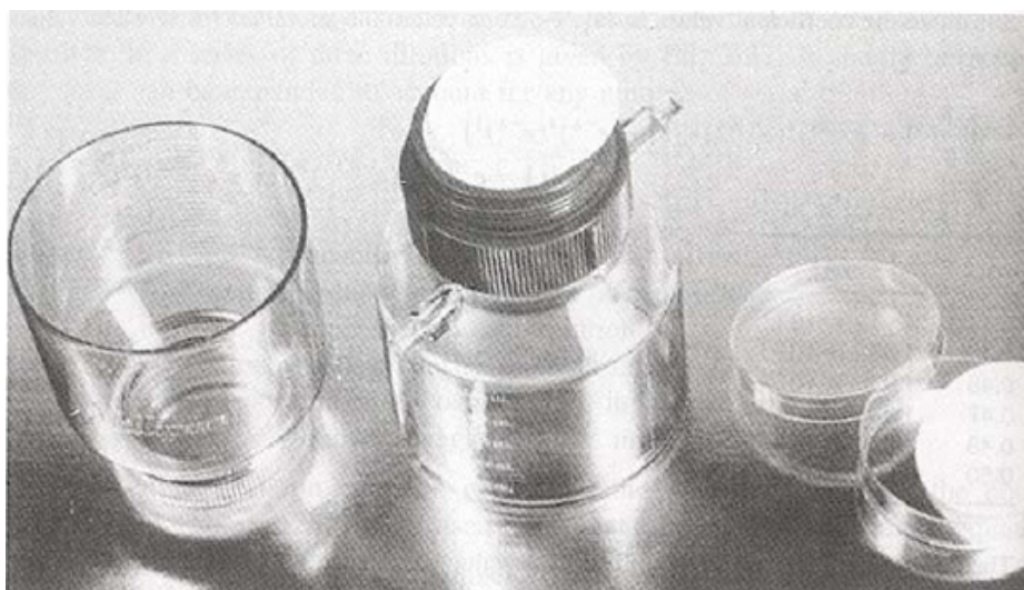
Figura A2.5.2: Esquema tipo de montagem para método da membrana filtrante. [12]
