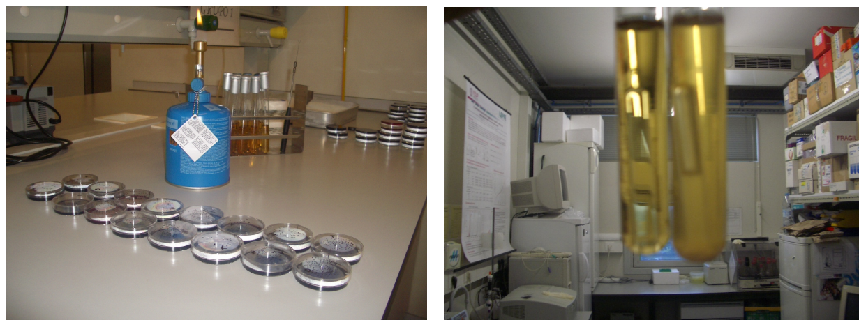
Figura A2.6.4: Método aplicado em comprovativos de Coliformes Fecais – esquerda e respectivos resultados ao teste – direita (positivo direita/negativo esquerda).
