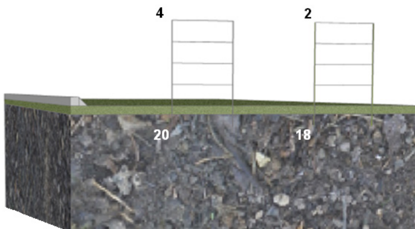
Fig.4.54 – Nós utilizados para controlo da resposta dinâmica
