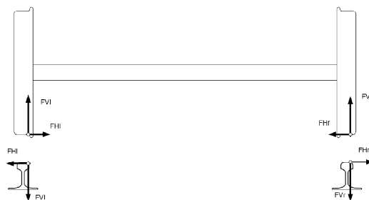
Fig.2.3 – Forças de contacto vertical e horizontal entre rodas e carril [1]
