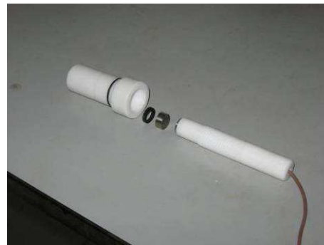
Figura 11 – Imagem da célula de polarização (à esquerda) e porta amostras (à direita) aplicadas na realização do ensaio em conformidade com ASTM G61-96.
