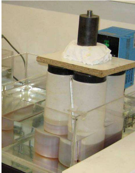
Figura 9 – Teste de avaliação de resistência à corrosão por picadas, norma G48-03, em desenvolvimento. O recipiente que contém a amostra está imerso num banho isotérmico para manutenção da temperatura; a temperatura real do banho é controlada por um termómetro em contacto com o banho.
