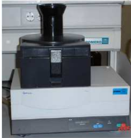
Figura A.9: Moinho de Retsch ZM-100.
