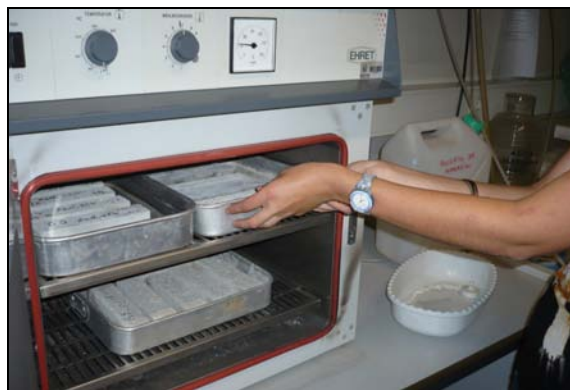
Figura 5.10 – Processo de secagem dos provetes com forma prismática numa estufa a 60 °C
