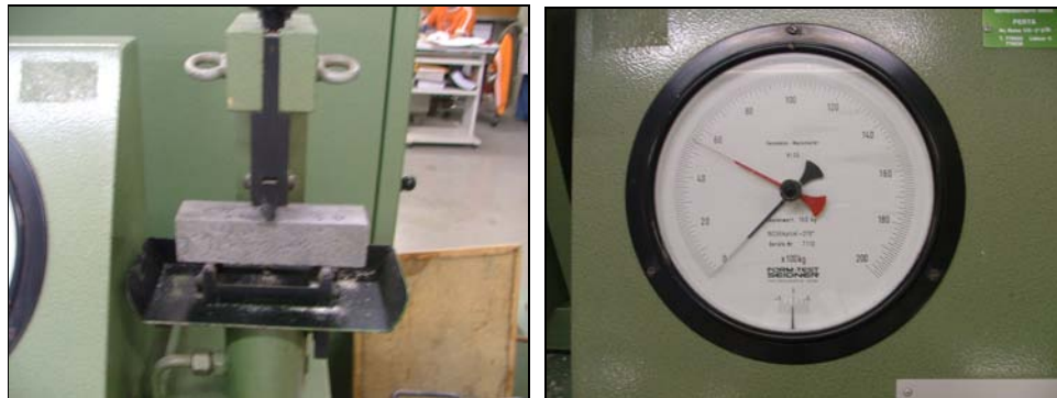
Figura 5.7 – Ensaio à flexão dos provetes de argamassa
