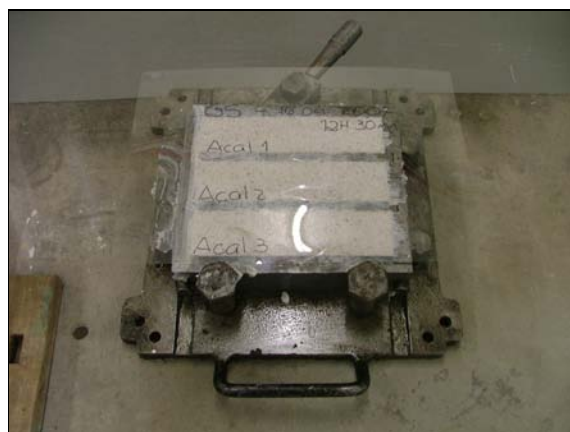
Figura 5.5 – Molde preenchido com argamassa de cal aérea
