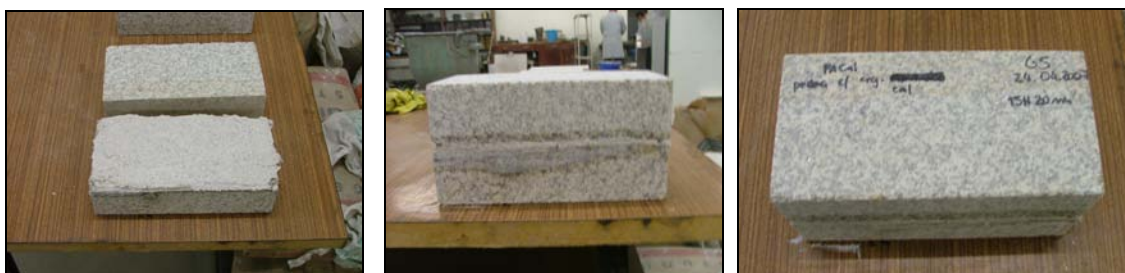
Figura 5.6 – Execução de um provete de granito do Porto e argamassa de cal aérea realizado no LEMC
