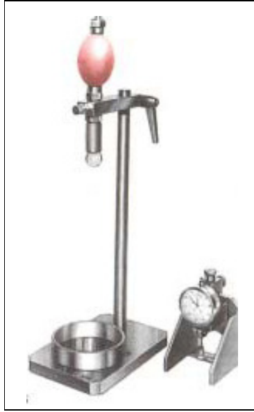
Figura 3.2 - Dispositivo utilizado para o ensaio de punção de penetração
