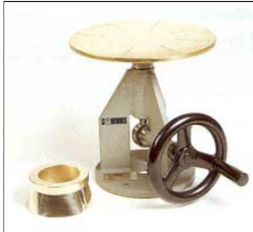
Figura 3.1 – Molde da argamassa e mesa de espalhamento
