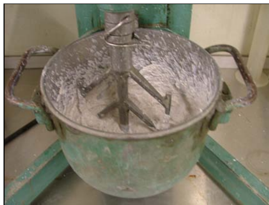
Figura 5.3 – Execução da amassadura da argamassa de cal aérea na misturadora mecânica realizada no LEMC
