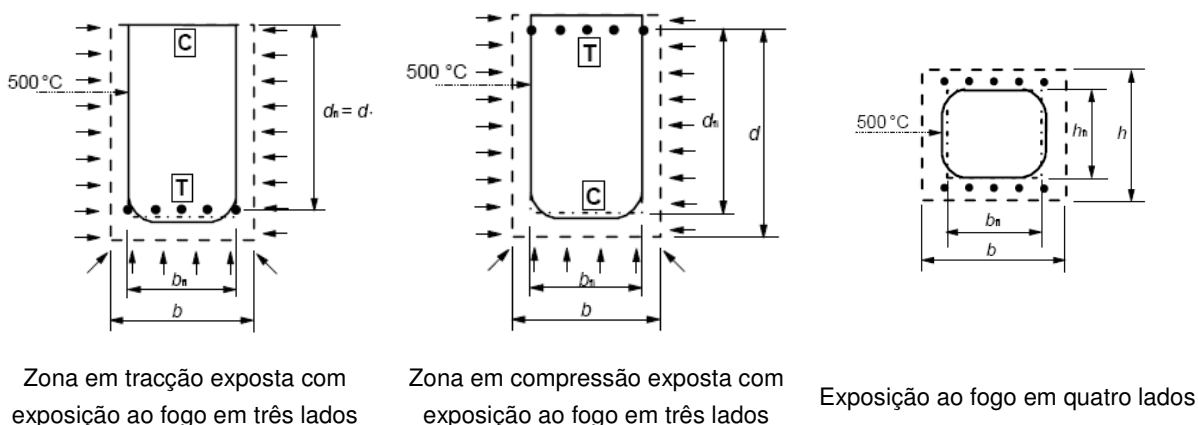
Figura 16 – Redução da área das secções pela Isotérmica dos 500^{\circ}\text{C}
