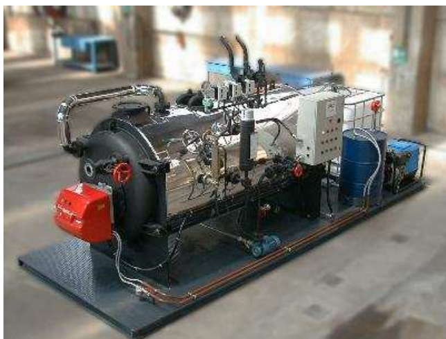
Figura 18. Caldeira de Secção Flash
