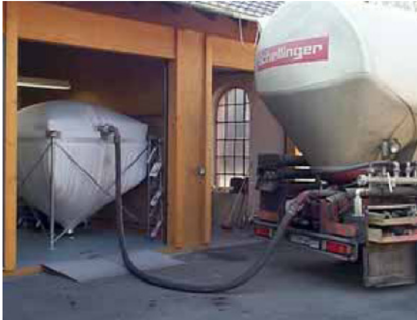
Figura 12 - Camião cisterna a abastecer um reservatório [Mann, 2006].
