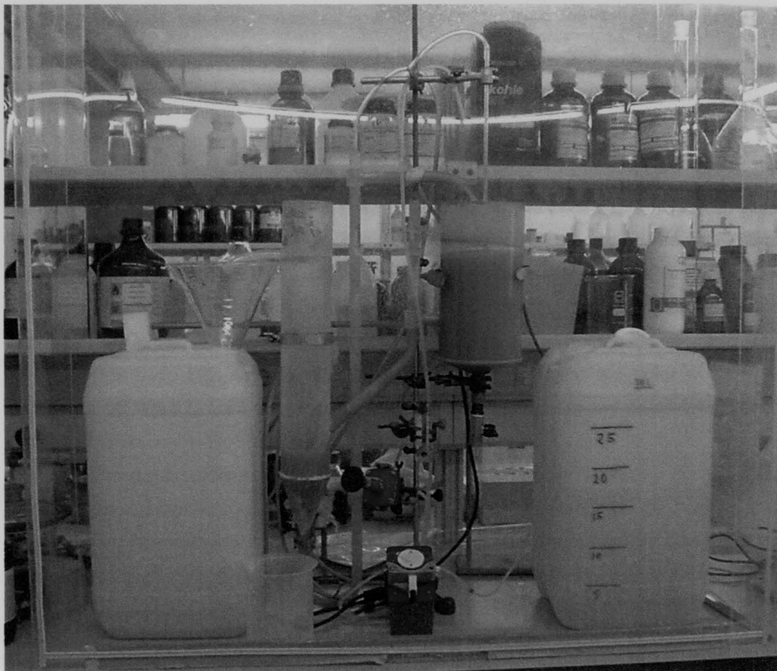
Figura 2.3 – Fotografia do sistema de lamas activado implementado, a funcionar em circuito aberto.
