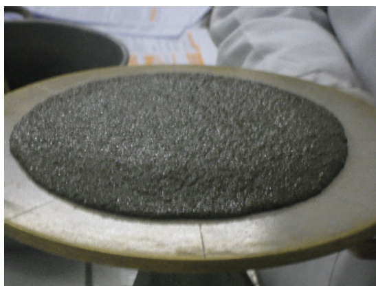
Fig.39 – Avaliação da trabalhabilidade de uma amassadura
