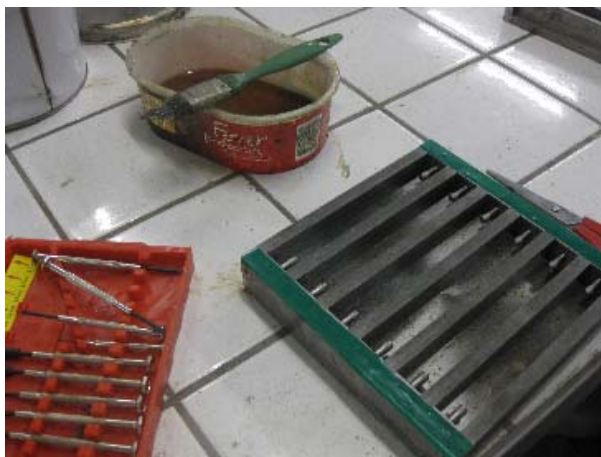
Fig.46 – Molde do ensaio de resistência ao ataque por sulfatos
