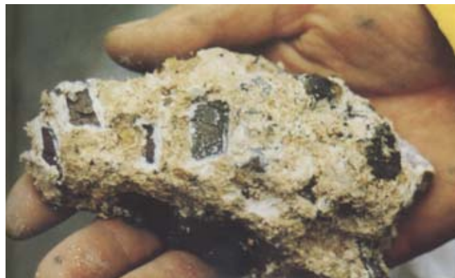
Fig.13 – Taumasite produzida por um ataque por sulfatos
