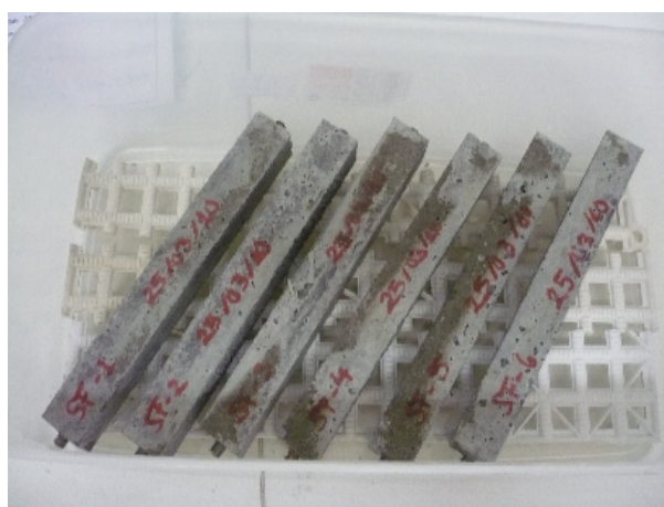
Fig.49 – Conservação dos provetes no ensaio de resistência ao ataque por sulfatos
