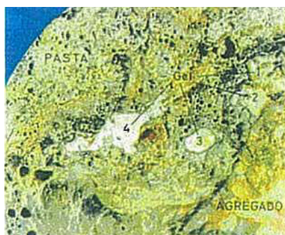
Fig.3 – Reacção álcalis-silica reactiva. Estados de alteração (1 a 4) de quartzo-filoneano em gel (Santos Silva, 1996).
