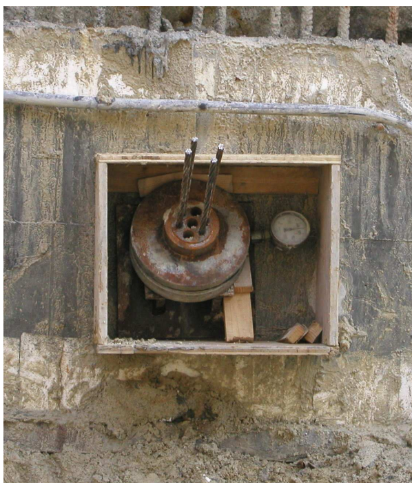
Figura 4.13 – Exemplo de uma célula de carga associada a uma ancoragem.
