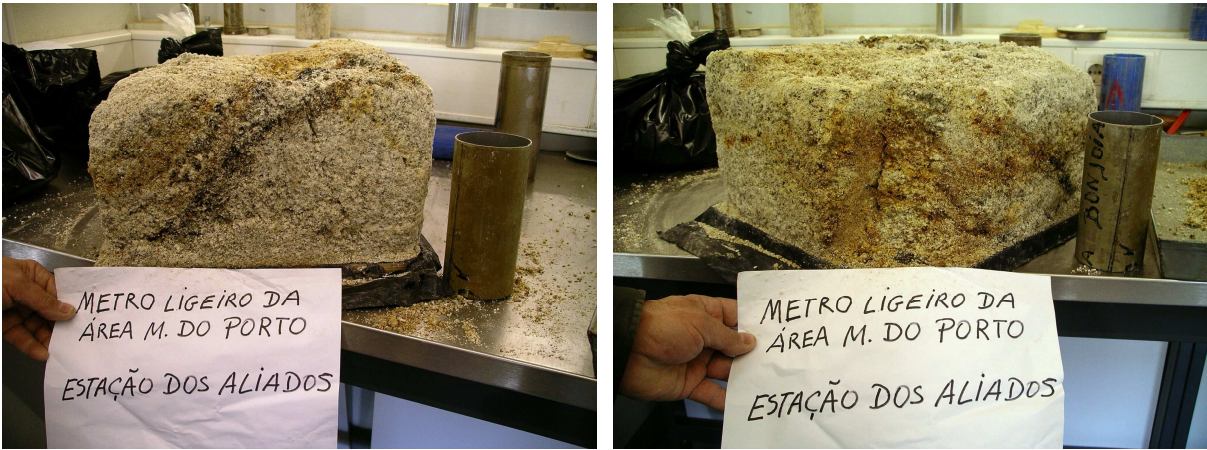
Figura 3.2 – Perspectivas do bloco no laboratório para a retirada dos provetes.
