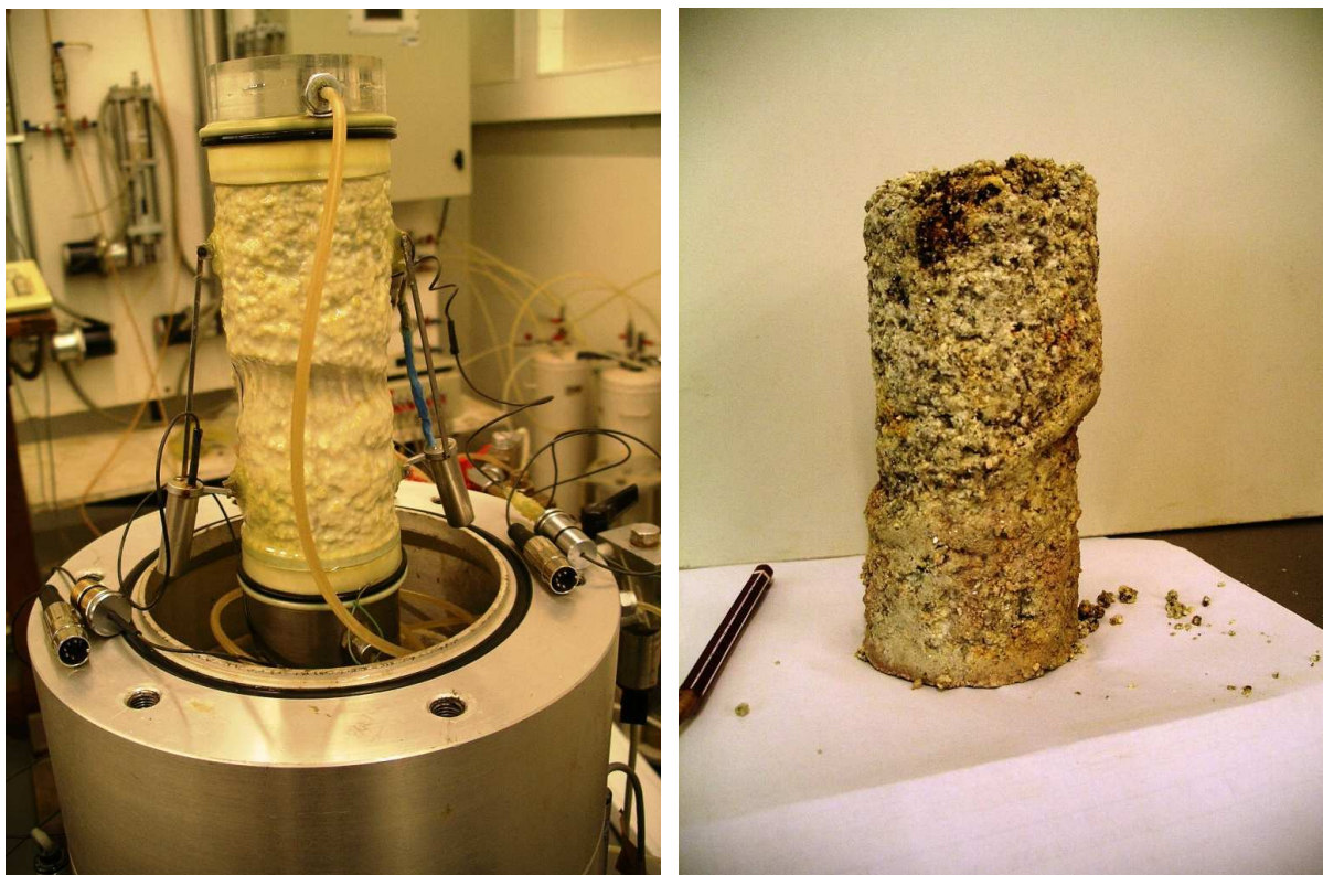
Figura 3.6 – Exemplo do provete Triax 1, que foi ensaiado à extensão.
