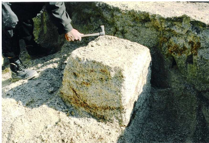
Figura 3.1 – Imagem do bloco retirado para ensaio no LabGeo ® , (fotografia de Viana da Fonseca, 2003).
