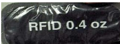
Figura 22. Etiqueta de RFID para altas temperaturas e pressões.
