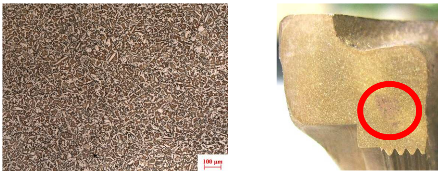
Figura 12 – Microestrutura de uma peça com defeito de poroso. Possui 60,7 % de fase \beta .
