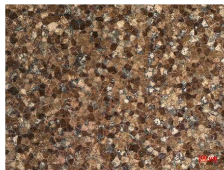
Figura 16 – Microestrutura da amostra chumbo alto.
