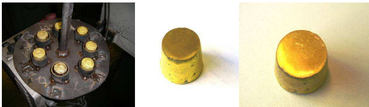
Figura 7 – Amostras para controlo da composição química.
