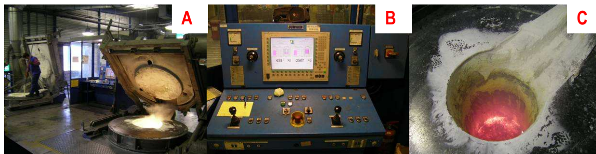
Figura 3 - Fornos de indução utilizados na fusão central. A - Vista geral dos fornos. B - Controlo dos fornos. C - Pormenor de um dos fornos.
