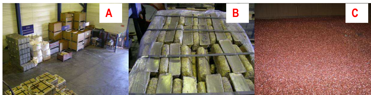
Figura 2 – Matérias-primas utilizadas na fusão central. A – Armazém das matérias-primas. B – Lingote. C – Cobre granulado.
