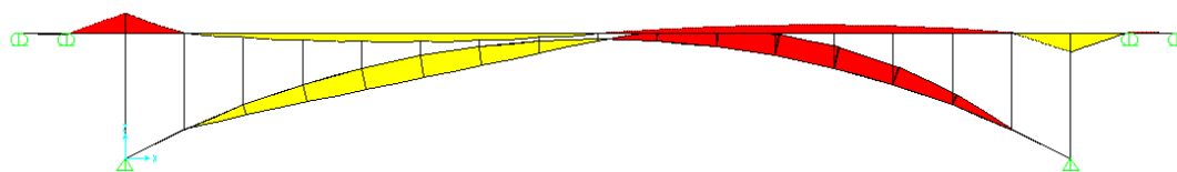
Fig. 4-44 – Arco 320 x 40, l/f 8, momentos flectores, carregamento anti-simétrico
