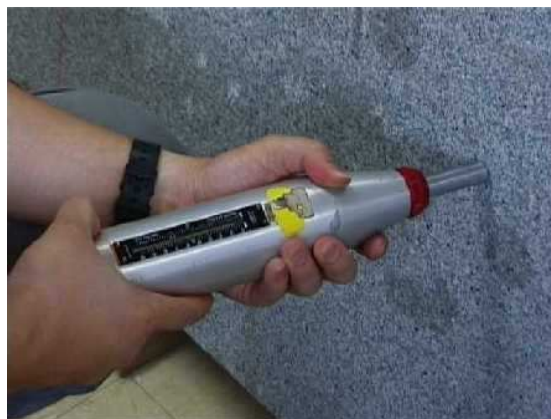
Figura 3.23 – Esclerómetro ou martelo de Schmidt.
