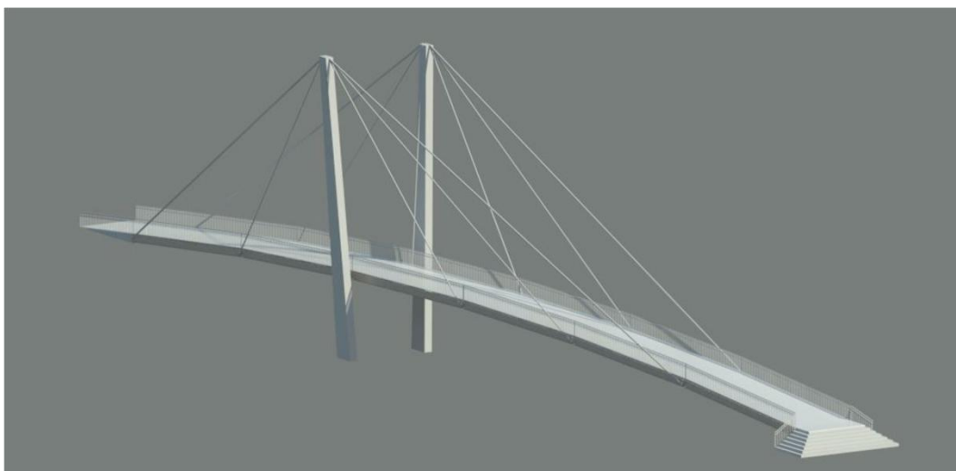
Figura 7.7 - Modelo tridimensional da ponte - Vista de Norte
