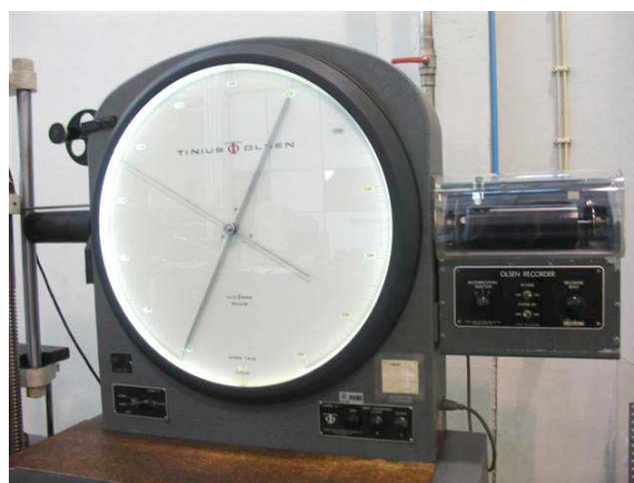
Figura 23 – Mostrador que permite determinar a força máxima
