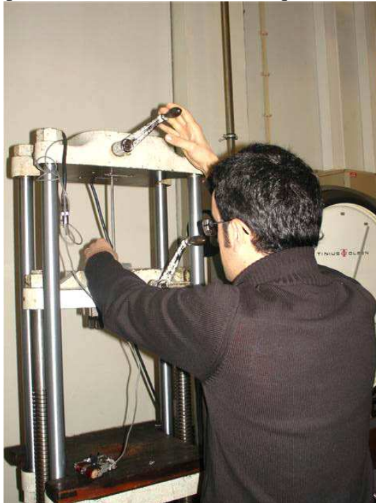
Figura 21 – Montagem do provete nas amarras da máquina de ensaio de tracção
