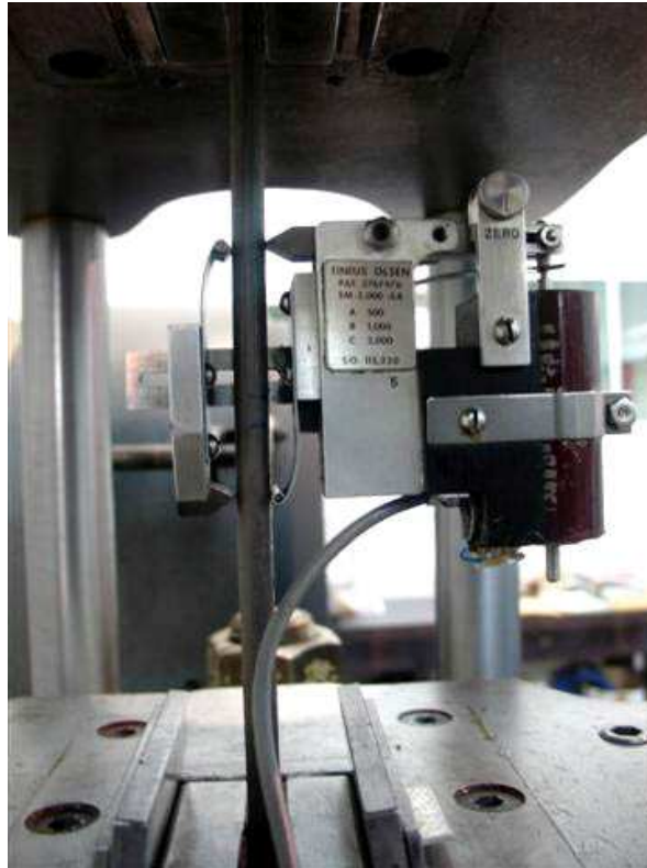
Figura 22 – Transdutor de deslocamento montado no provete
