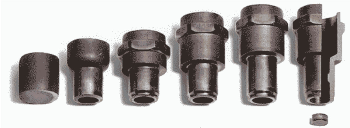
Figura 5 – Esboço inicial, pré-formas e resultado final de uma sequência de forjamento a frio
