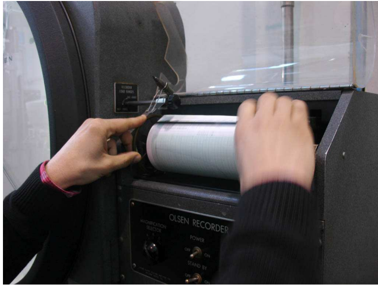
Figura 20 – Colocação do papel milimétrico no rolo onde será registado o gráfico Força vs Deslocamento
