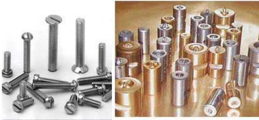
Figura 7 – Exemplos de peças obtidas por encabeçamento (esquerda) e de ferramentas usadas na conformação deste tipo de componentes (direita)
