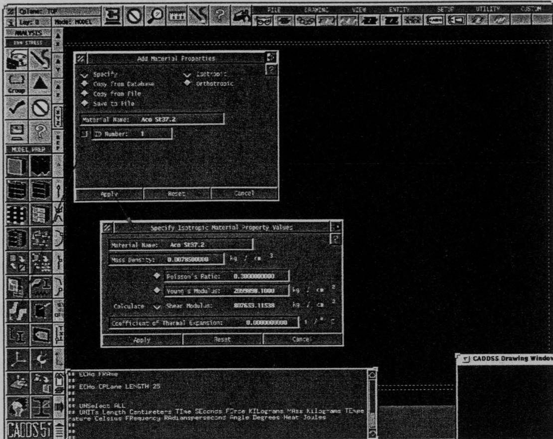
Figura. Definição das propriedades de um material no menu MODEL PREP do StressLab
