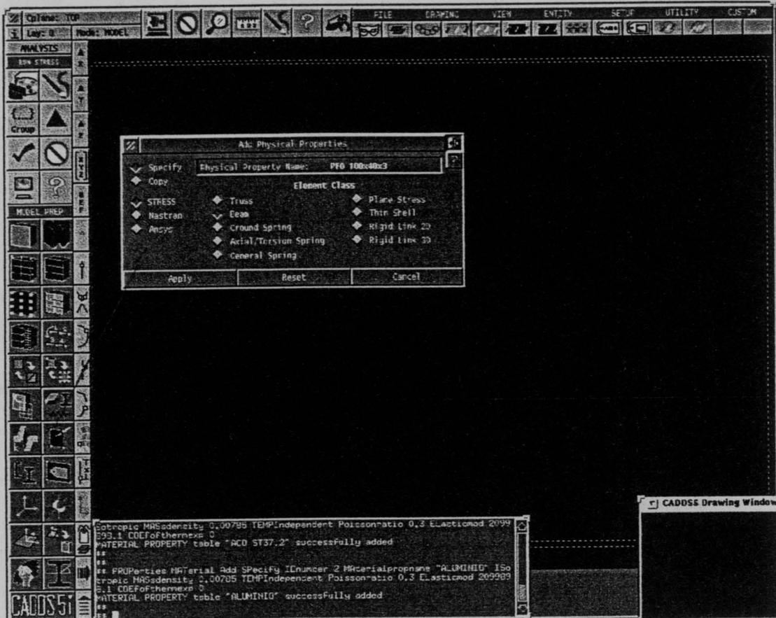
Figura. Primeiro passo na definição das propriedades físicas de um elemento viga
