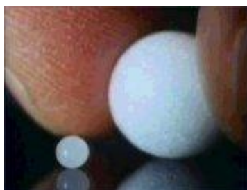
Figura 2.5: Diferença de volume entre um grânulo de poliestireno expansível (areão) e, um grânulo de poliestireno expandido [22]
