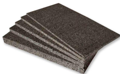
Figura 2.6: Aglomerados de cortiça expandida.
