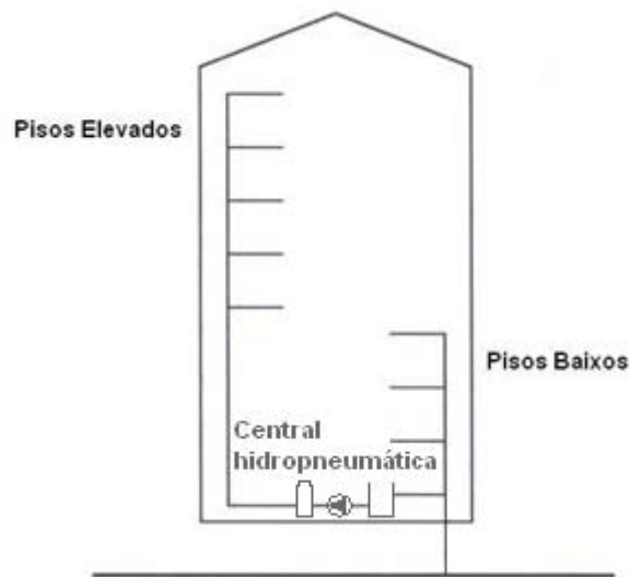
Fig. 3.2 – Esquema de central hidropneumática em edifícios altos
