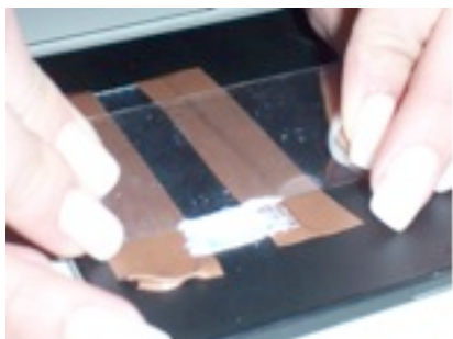
Figure 3.1.3.1. Técnica da aplicação do filme de nanopartículas de TiO 2
