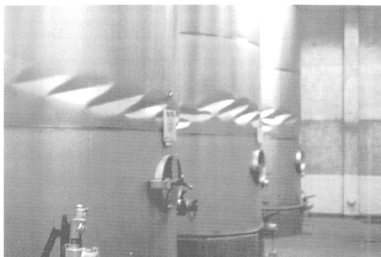
Figura 6 – Deformação por encurvadura do tipo diamante
