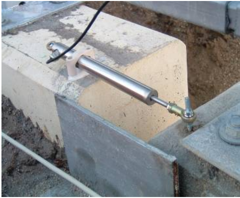
a) Medição dos movimentos nas juntas - LVDT
