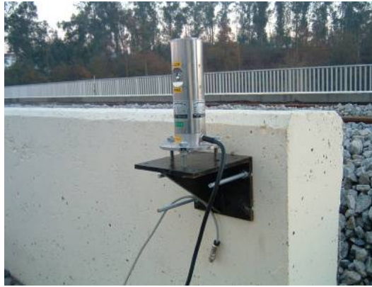
b) Medição de rotações do tabuleiro – inclinómetro.
