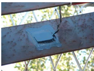
a) Aplicação de sensores tipo I e clássicos numa mesma secção.
