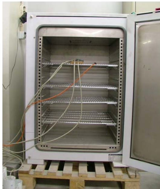
Figura 3.18 – Câmara climática usada nos ensaios térmicos.
