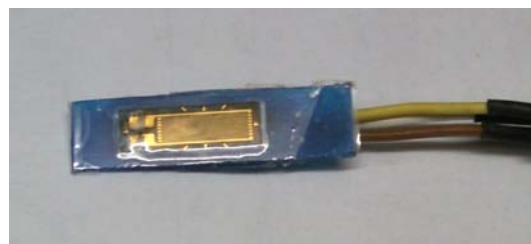
b) Extensómetro de resistência encasulado numa base em resina epóxi (Sensor tipo II).
