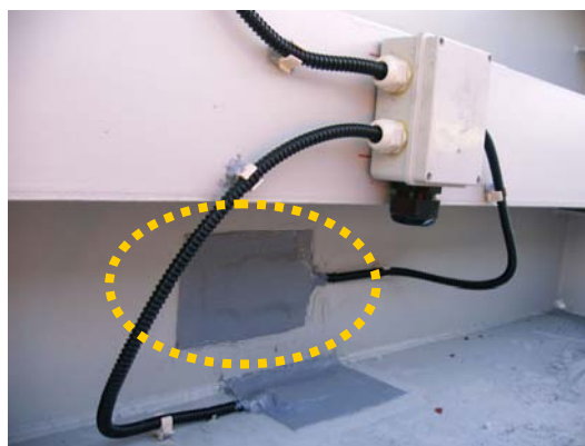
b) Sensor para a medição da temperatura do aço na secção S5 (TS5_Sul).
