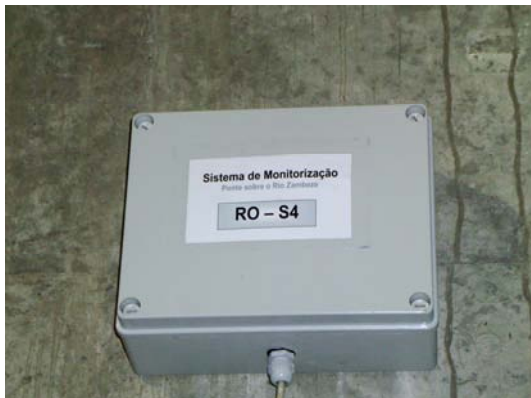
a) Protecção ambiental do inclinómetro em aplicações de longa duração.
