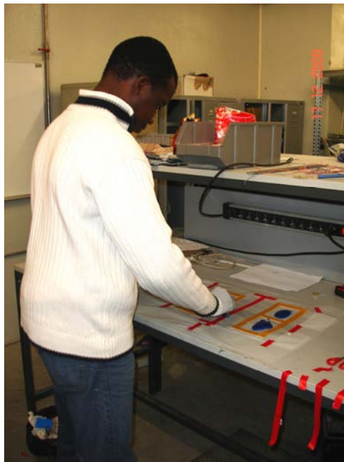
a) Fabrico das placas em resina epóxi.
