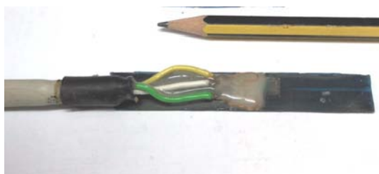
a) Extensómetro de resistência encapsulado numa base compósita em CFRP (Sensor tipo I).
