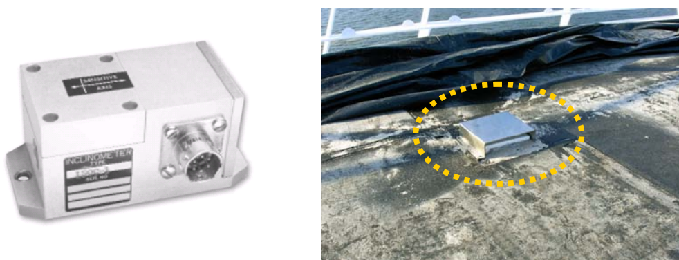
a) Inclinómetro utilizado na medição das variações angulares do tabuleiro.
