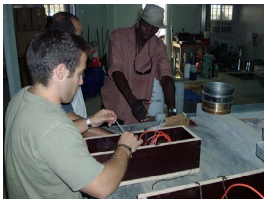
a) Execução de moldes para prismas durante a acção de formação no laboratório da obra.
