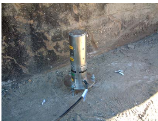
a) Inclinómetro eléctrico biaxial – Modelo KB-1AC.
