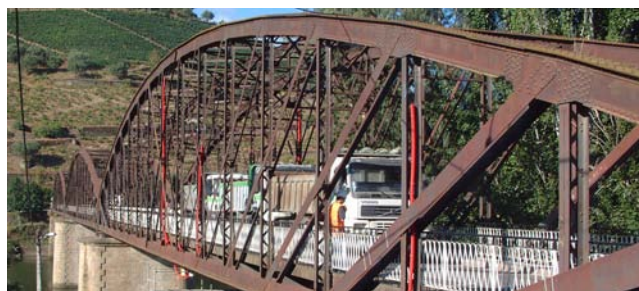
b) Condução de um ensaio de carga na ponte.
