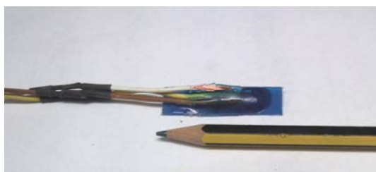
b) Extensómetro de resistência encasulado numa base em resina epóxi (Sensor tipo II).
