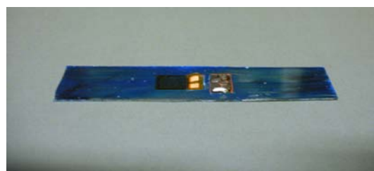
a) Extensómetro de resistência encapsulado numa base compósita em CFRP (Sensor tipo I).
