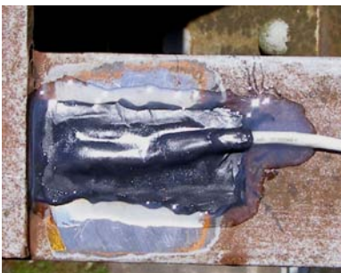
c) Borracha moldável aplicada sobre um sensor.
