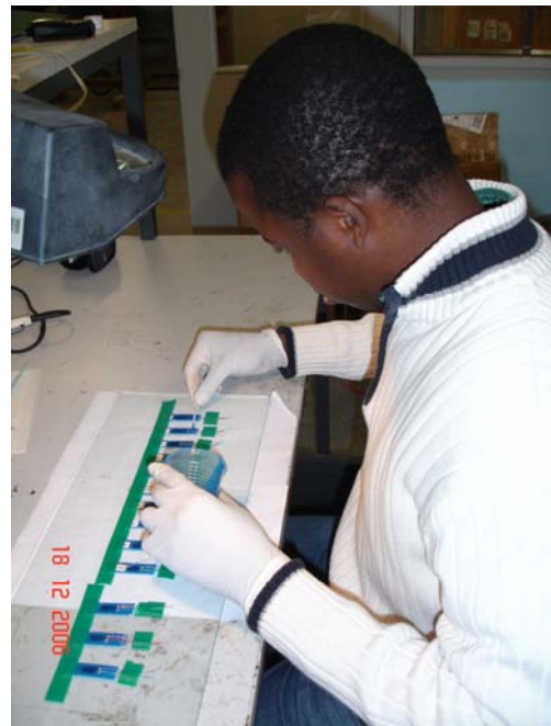
b) Inserção dos extensómetros de resistência em bases em resina e soldagem dos fios condutores.
