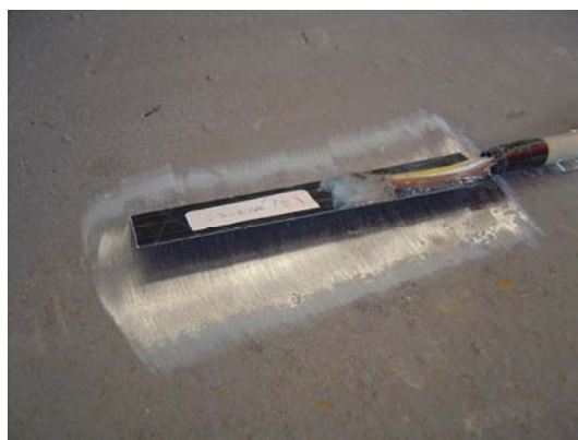
b) Sensor pronto a ser aplicado à superfície metálica já tratada.
