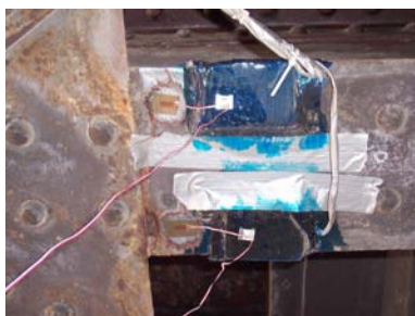
a) Aplicação de sensores tipo I e clássicos numa mesma secção.
