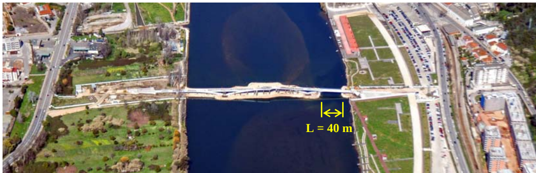
Figura 5.9 – Redução do canal do rio para uma largura de 40 m.
