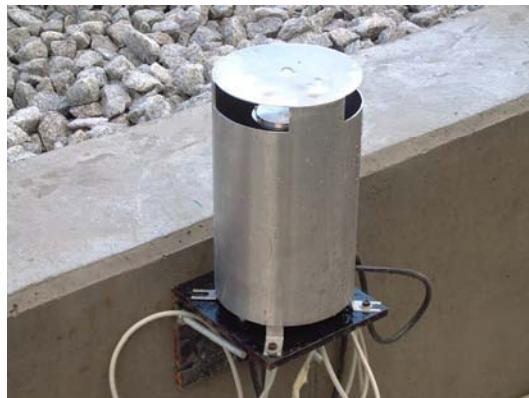
b) Protecção do inclinómetro contra impactos em aplicações de curta duração (por exemplo durante a realização de um ensaio de carga rápido).
