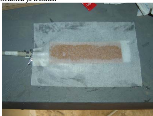
d) Aspecto da cortiça e do tecido polyester colados sobre o sensor.
