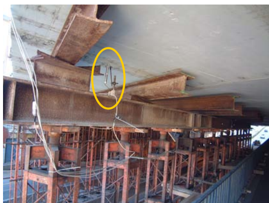
c) LVDT instalado numa base porticada.
