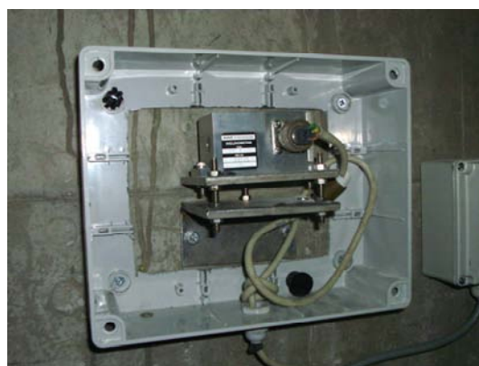
b) Inclinómetro eléctrico uniaxial – Modelo LSOC 1L.
