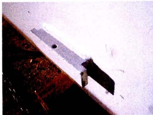
Figura 41 – Foto da peça de ancoragem para os macacos hidráulicos do mastro de 75.75m após ter sido sujeita a uma carga de 14 toneladas.
