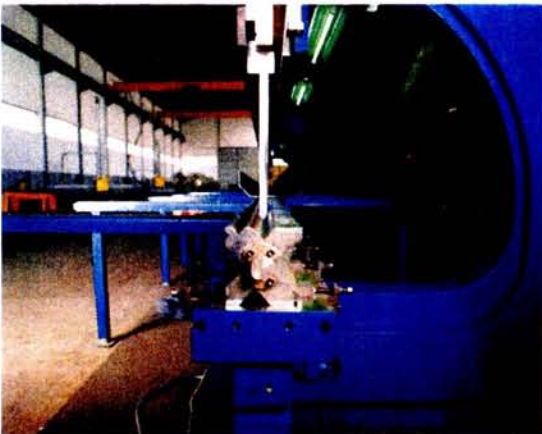
Figura 36 – Foto de uma peça durante o processo de quinagem (Metalgalva).
