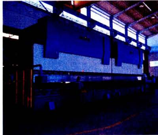
Figura 37 – Foto global da prensa de quinagem de 12m (Metalgalva).
