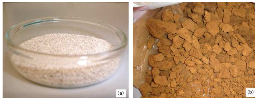
Figura III. 3 – Fotografias dos adsorventes: (a) Sepiolite e (b) Lama Residual contendo hidróxidos metálicos.
