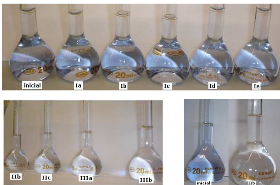
Figura VII. 5 – Fotografias do efluente D (diluição 1:40) antes e após tratamento segundo as condições experimentais de cada ensaio.
