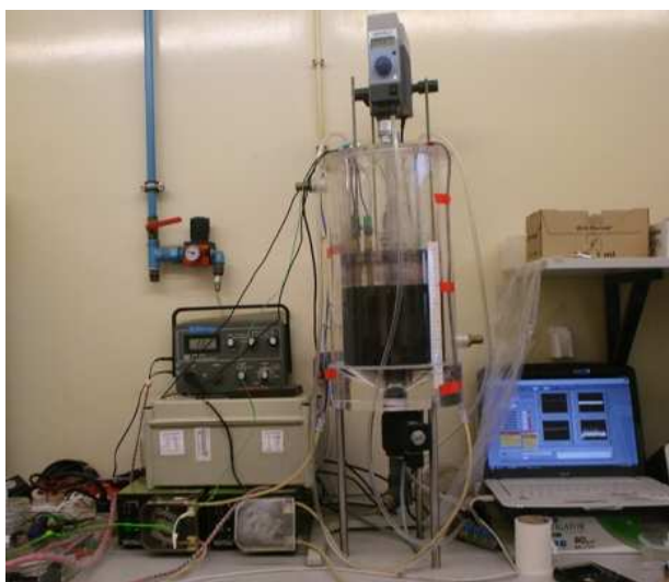
Figura VII. 1 – Instalação experimental do SBR.
