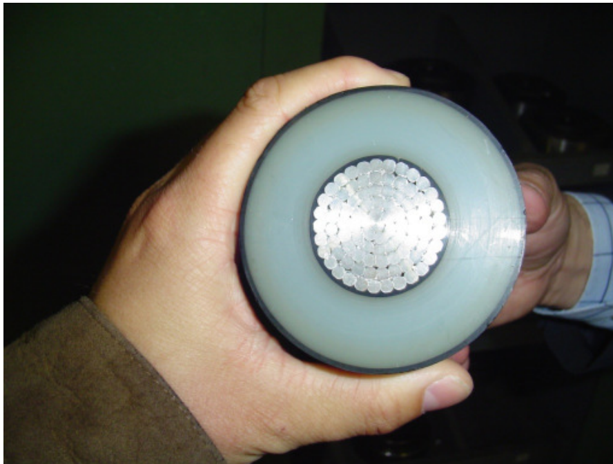
Figura 35- Cabo de média tensão de 240mm
