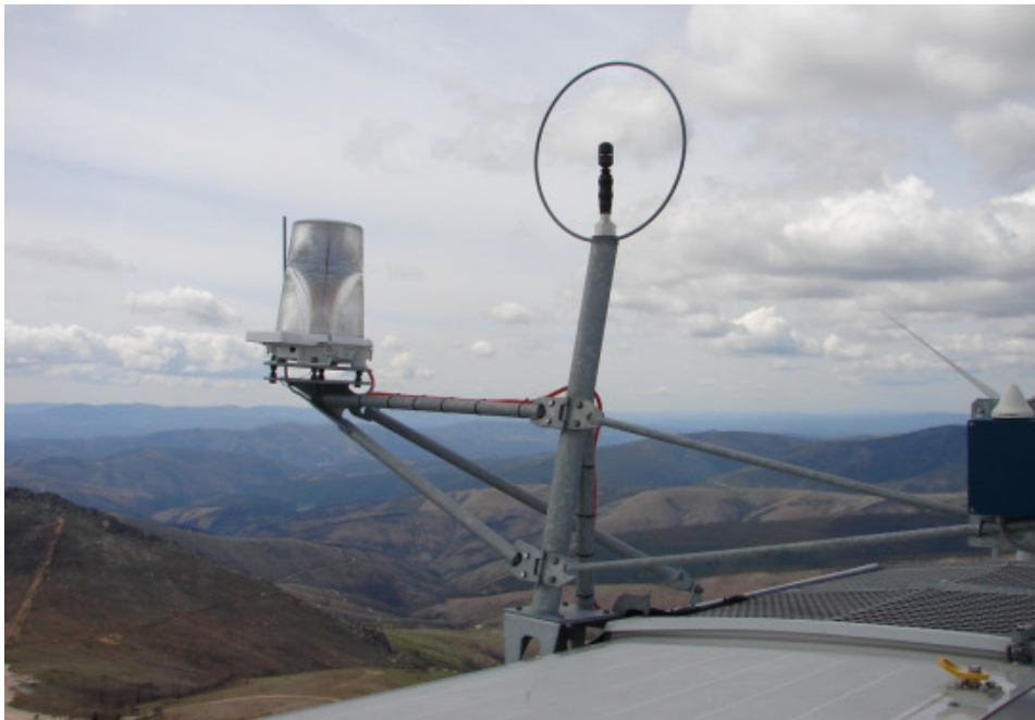
Figura 42 – Anemómetro ultra-sónico na cabine de um aerogerador, com fornecimento em tempo real da velocidade e direcção do vento
