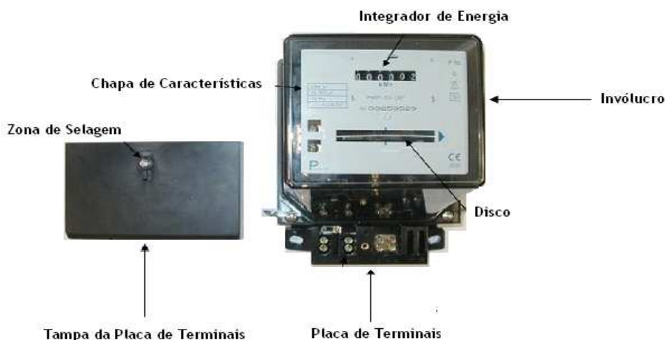
Figura 3.7: Constituição de um Contador electromecânico [13].
