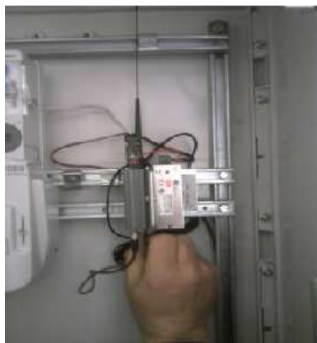
Figura 4.27: Inserção do Cartão SIM no Modem.
