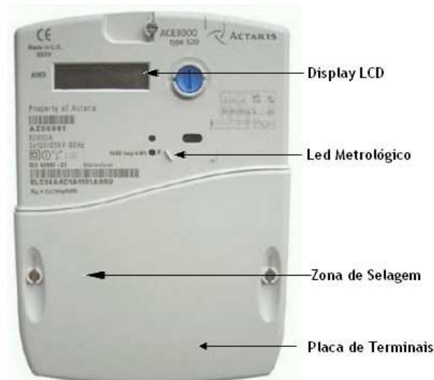
Figura 3.8: Constituição de um Contador Estático.
