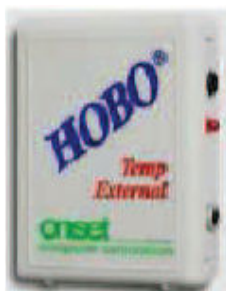
Fig. 31 – Sensor utilizado nas medições “in situ”
