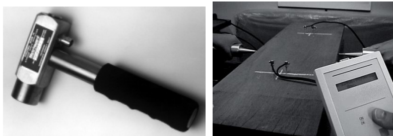
Fig. 3.2 – Aparelhos para vibração induzida. À esquerda martelo de impacto e à direita medidor de velocidades de propagação de ondas.
