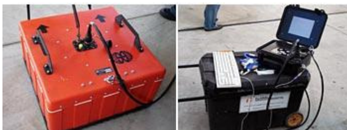
Fig. 3.6 – Unidade central e antena de um georradar.
