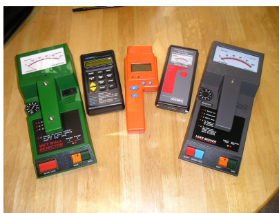
Fig. 3.3 – Alguns tipos de higrómetros existentes no mercado.
