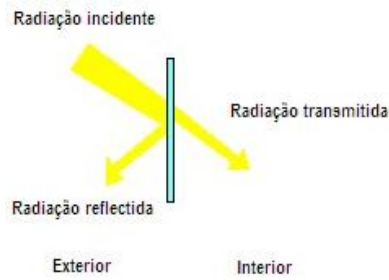
Fig.5.5. – Radiação incidente vs. radiação transmitida [10]
