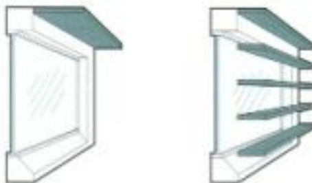
Fig.5.7. – Protecções solares horizontais projectadas [10]
